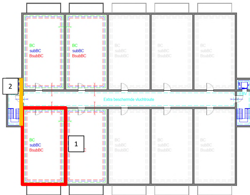
Figuur B3.2-1 Verdedigingslijnes in woongebouw met corridor
