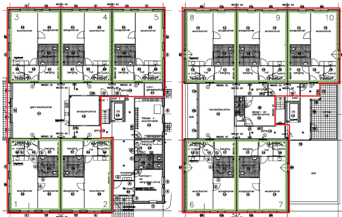
Figuur 5 Plattegrond begane grond (links) en verdieping (rechts) met indeling subbrandcompartimenten (rood) beschermd subbrandcompartimenten (groen)
